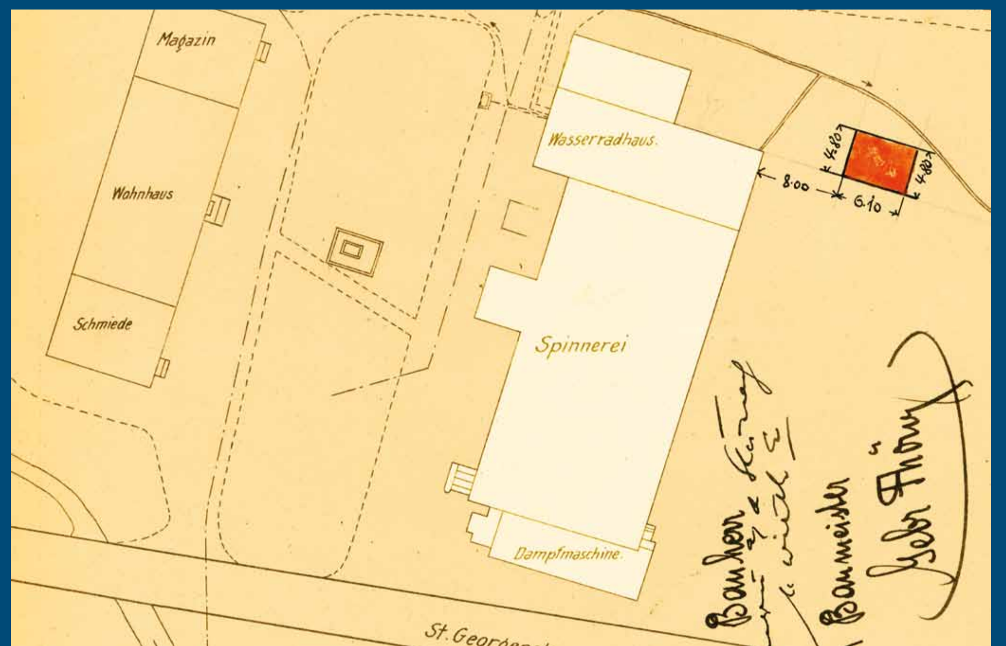
Situationsplan der Spinnerei mit dem Wasserradhaus und dem Standort der Dampfmaschine; 1917.
